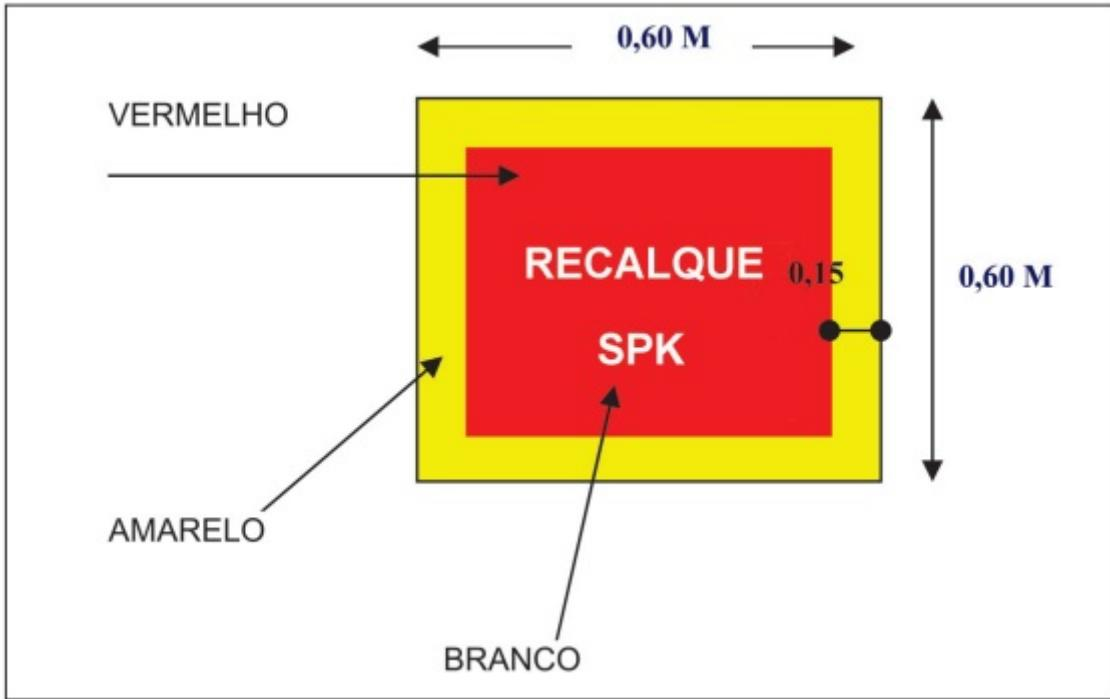
**OBSERVAÇÃO:** O REGISTRO DE RECALQUE DO SISTEMA DE HIDRANTES DEVERÁ SER SINALIZADO DA MESMA FORMA ACIMA, PORÉM SUBSTITUINDO-SE AS LETRAS “SPK” POR “HID”.
