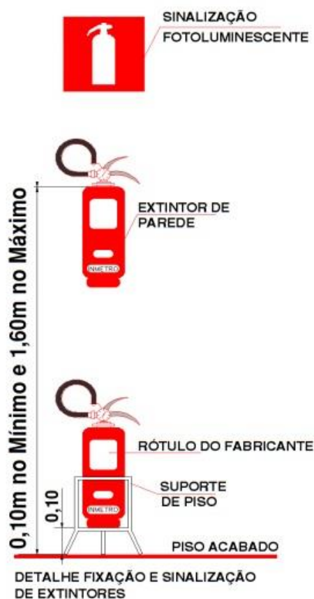
Figura 1 - Fixação de extintor
