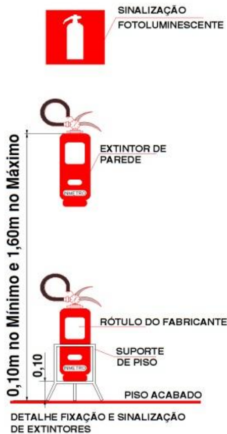
Figura 1 - Fixação de extintor
