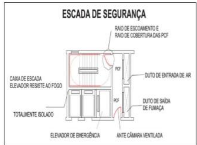
Figura 44: Escada e elevador à prova de fumaça
